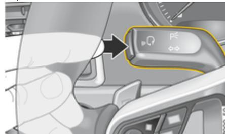
Fig. 12: Touche de commande vocale sur le levier de commande
