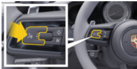
図 15: ボイスコントロールボタンを備えたステアリングホイール
