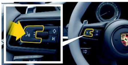
Fig. 18 : Touche de commande vocale au volant
