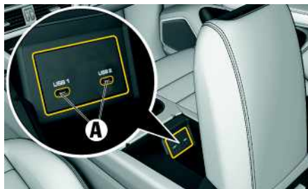
図 7: アームレスト内の USB インターフェース (タイプ C)
