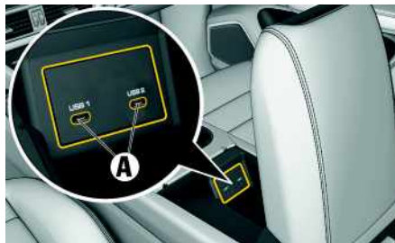
Abb. 2: USB-Schnittstelle (Typ C) in der Armlehne
