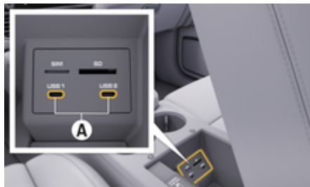
図. 2: アームレスト内の USB インターフェース (タイプ C)
