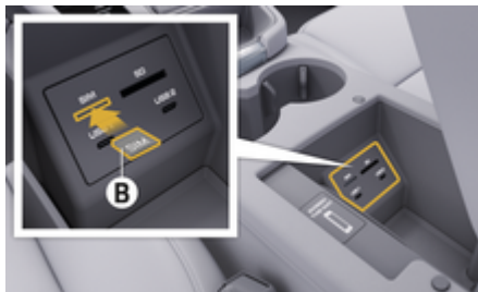
Kuva . 1: Ulkoisen SIM-kortin asettaminen käsinojaan
