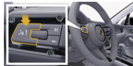
Рис. 4: Кнопка голосового управления на переключателе
