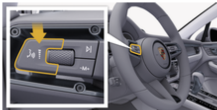
Рис. 13: Кнопка голосового управления на переключателе
