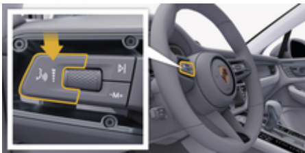
Рис. 3: Кнопка голосового управления на переключателе
