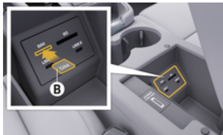
Fig. 1: Inserimento della scheda SIM esterna nel bracciolo
