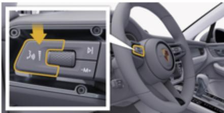
Abb. 13: Sprachbedientaste am Bedienhebel
