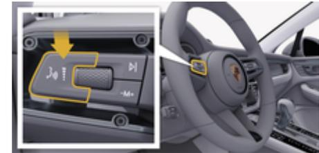
Abb. 4: Sprachbedientaste am Bedienhebel
