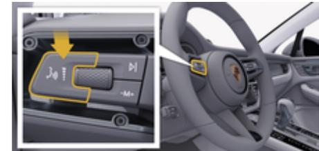
Abb. 10: Sprachbedientaste am Bedienhebel
