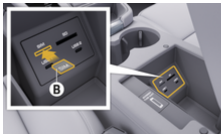
Rys. 1: Wkładanie zewnętrznej karty SIM do podłokietnika
