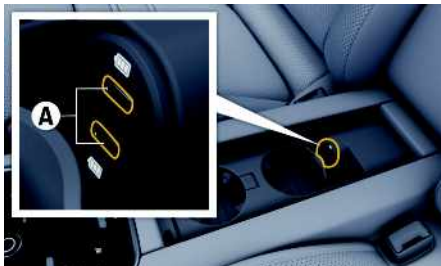
図 10: リヤセンター アームレスト内の USB インターフェース (タイプ C)
