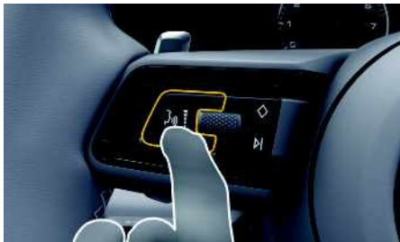
図 11：マルチファンクション ステアリング ホイールのボイスコントロール ボタン
