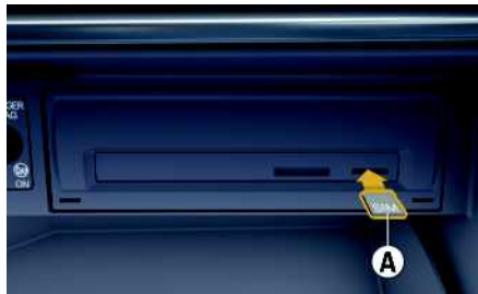
Kuva 1: Ulkoisen SIM-kortin asettaminen paikalleen ja poistaminen
