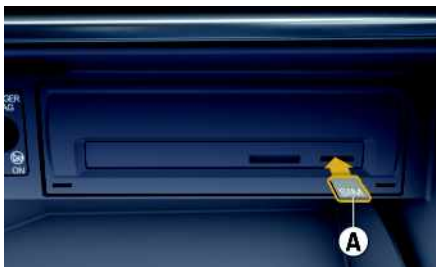
Рис. 1: Установка и извлечение внешней SIM-карты
