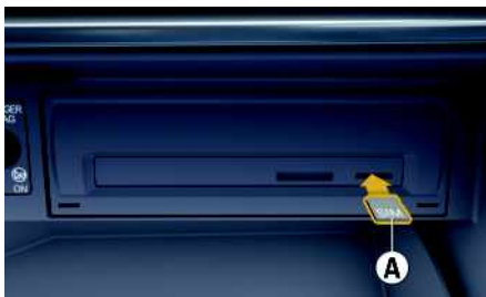
Fig. 1: Inserimento e rimozione della scheda SIM esterna
