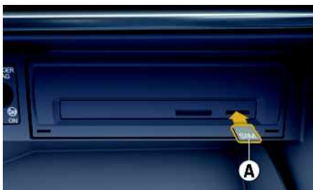
Joonis 1: Välise SIM-kaardi paigaldamine ja eemaldamine
