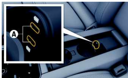
Joonis 3: USB-pesa (tüüp C) tagumises keskmises käetoos
