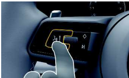
Bild 4: Röststyrningsknapp på flerfunktionsratten
