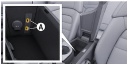
Rys. 3: Port USB (typ C) w podłokietniku
