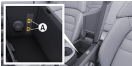
Rys. 1: Port USB (typ C) w podłokietniku
