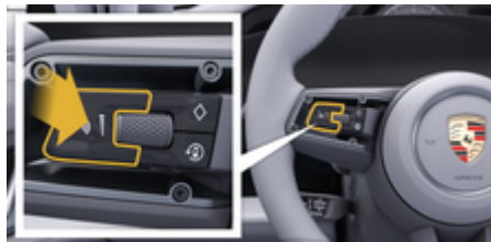
Rys. 4: Przycisk obsługi głosowej na kierownicy
